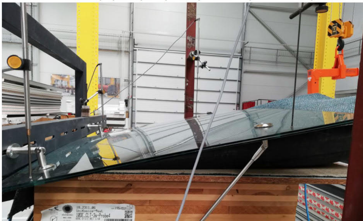
Zdeformowana markiza przy maksymalnym obciążeniu w danym teście 10 kN/m 2
