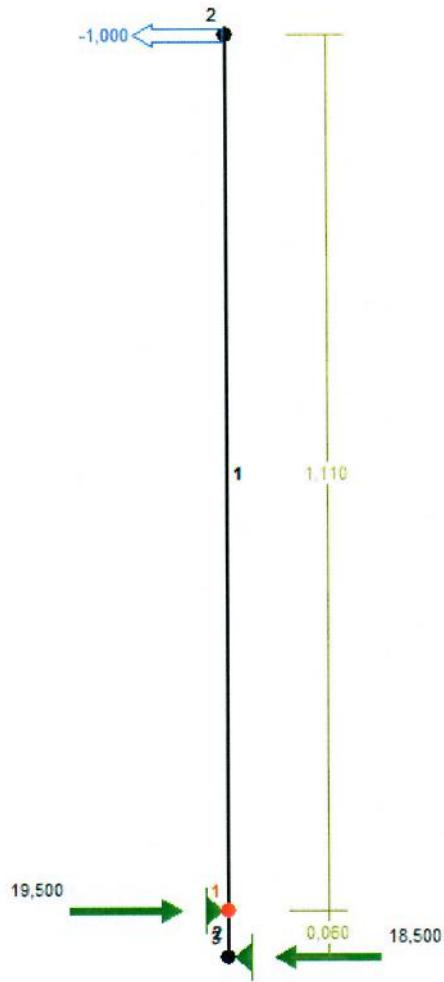
Wyznaczenie sił działających na wkładki przenoszące obciążenie na ścianki profilu (obciążenia charakterystyczne):
