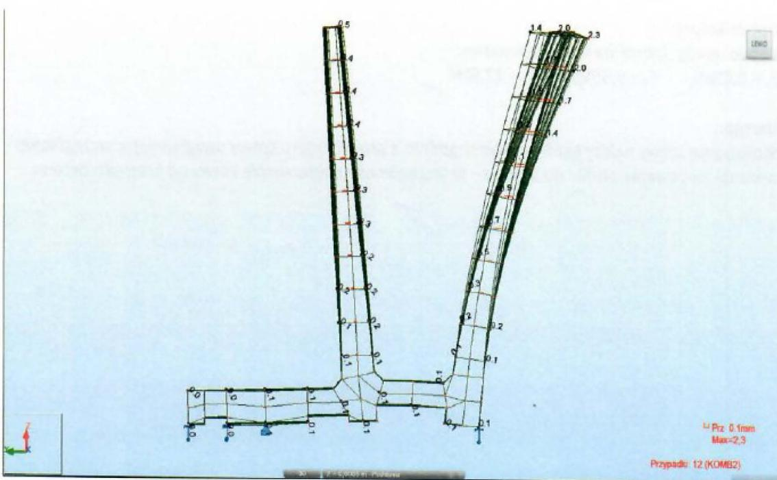
Maximálne vychýlenie zvislej steny profilu činí **2,3mm**.
