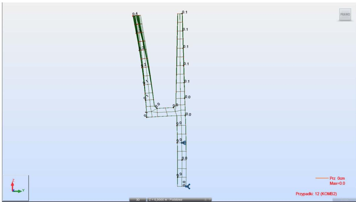
Maksymalne wychylenie ściany pionowej profilu wynosi **4mm**.
