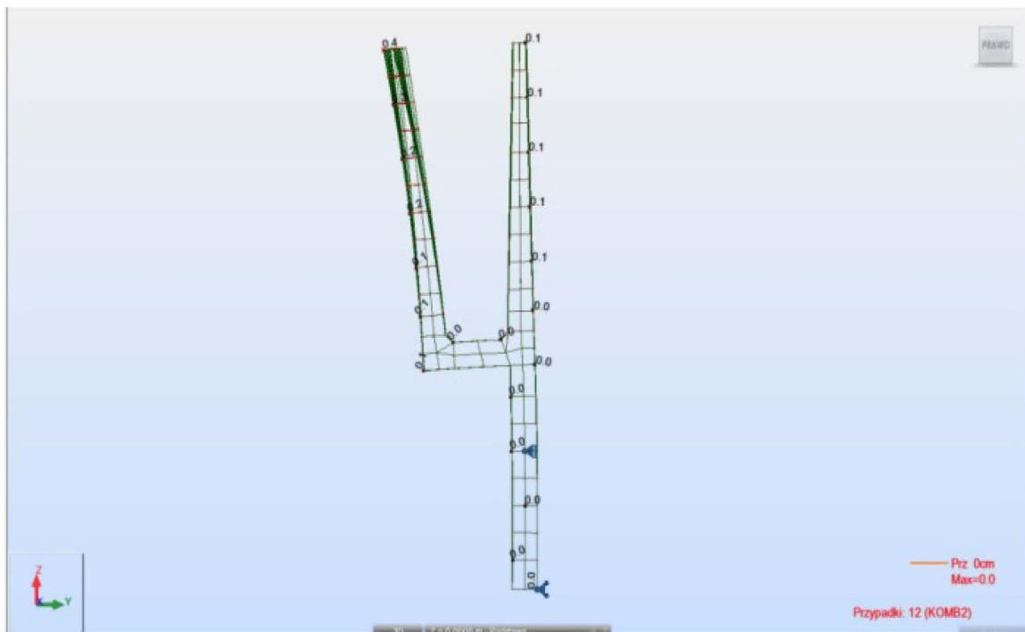
Maximálne vychýlenie zvislej steny profilu činí **4mm**.
