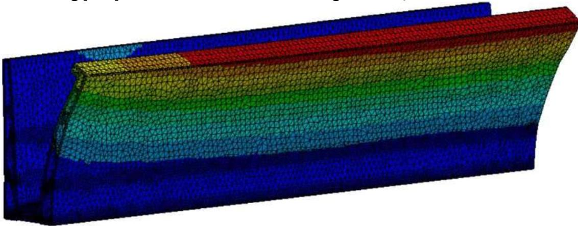
Maximale Verformung des Profils beträgt 1,26 mm.
