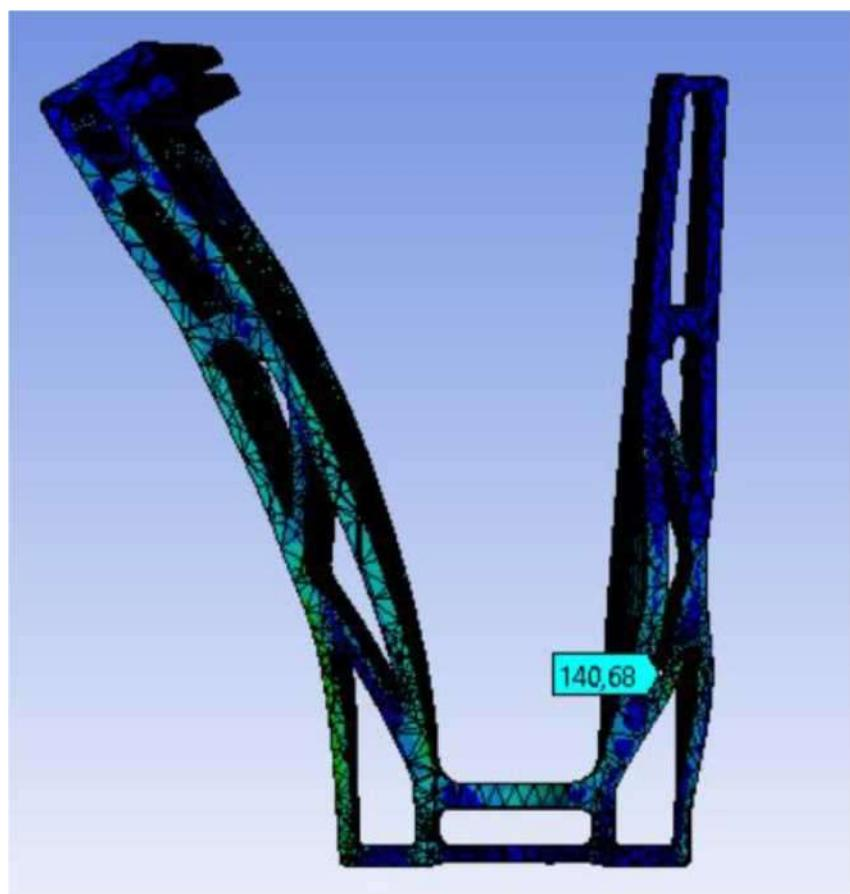
Maximale Spannung am Profil beträgt 140,68 MPa.
