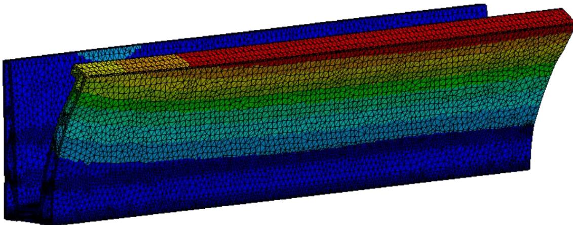
Maximálna deformácia profilu je 1,26 mm.
