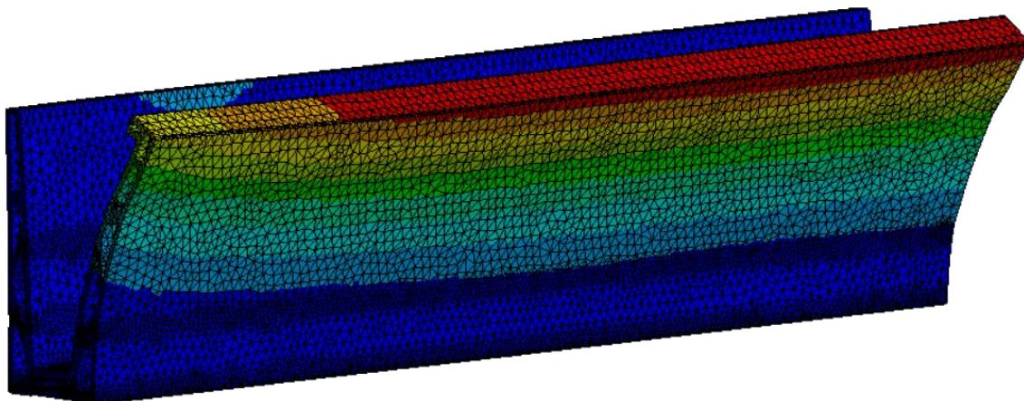
A profil maximális deformációja 1,26 mm.
