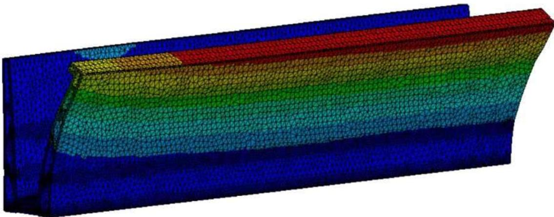
Maksymalne odkształcenie profilu wynosi 1,26 mm.
