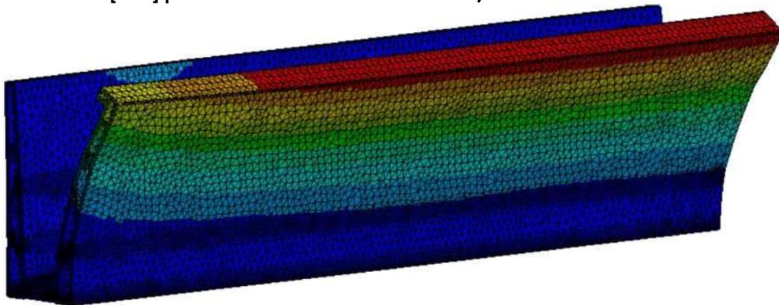
Maximální deformace profilu je 1,26 mm.
