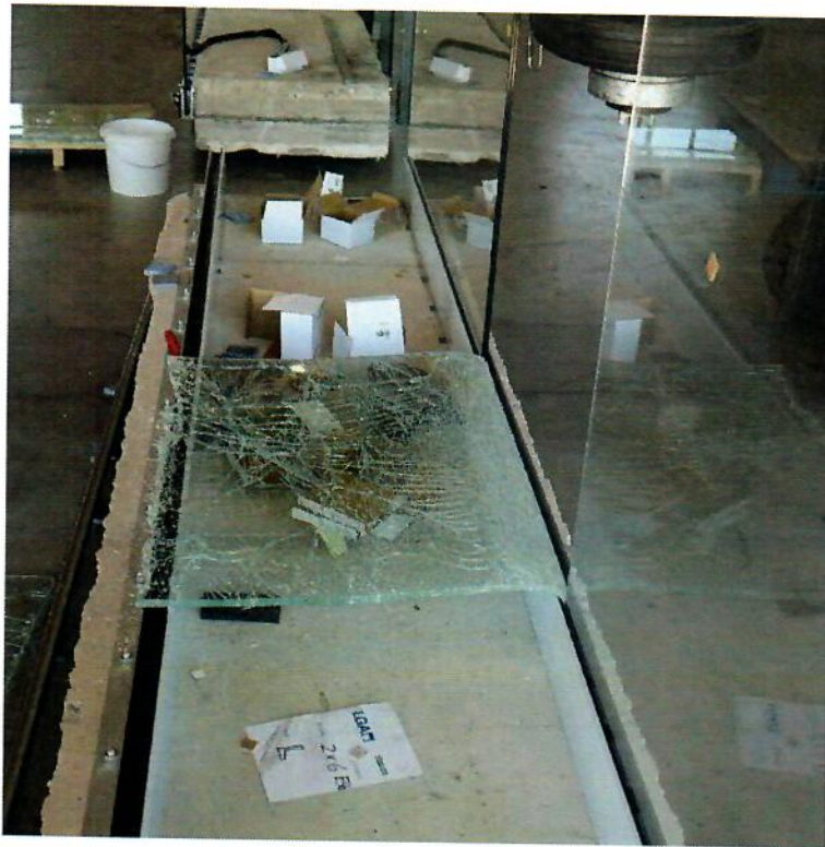
Abbildung V 02-11 Scheibe 1 nach Stoß auf Punkt 1
