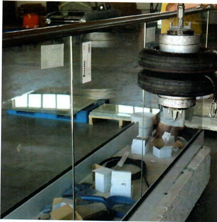
Abbildung V 02-9 Scheibe 1 nach Stoß auf Punkt 1
