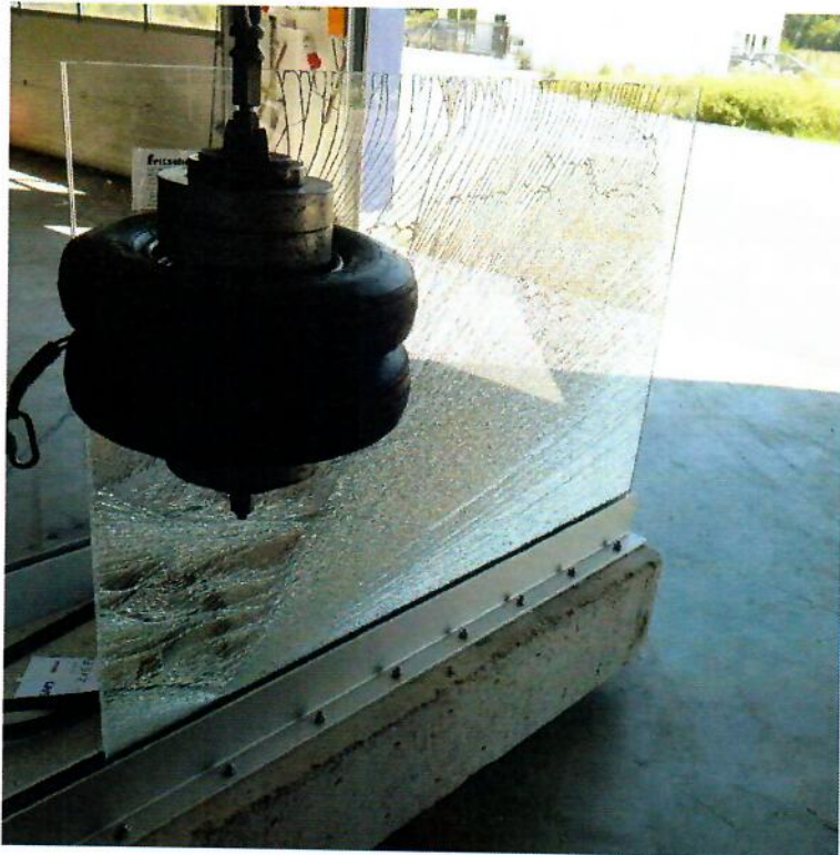
Abbildung V 01-15 Stoß auf Punkt 1 der Scheibe 2, Bruch der Stoß zugewandten Scheibe
