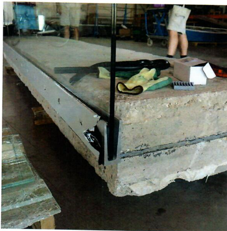
Abbildung V 03-4 Seitenansicht Profil System AL-0005 nach Abschluss der Versuche
