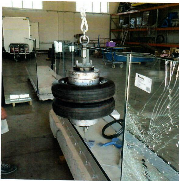
Abbildung V 01-20 Pendel ausgerichtet auf Stoßpunkt 1, Scheibe 3
