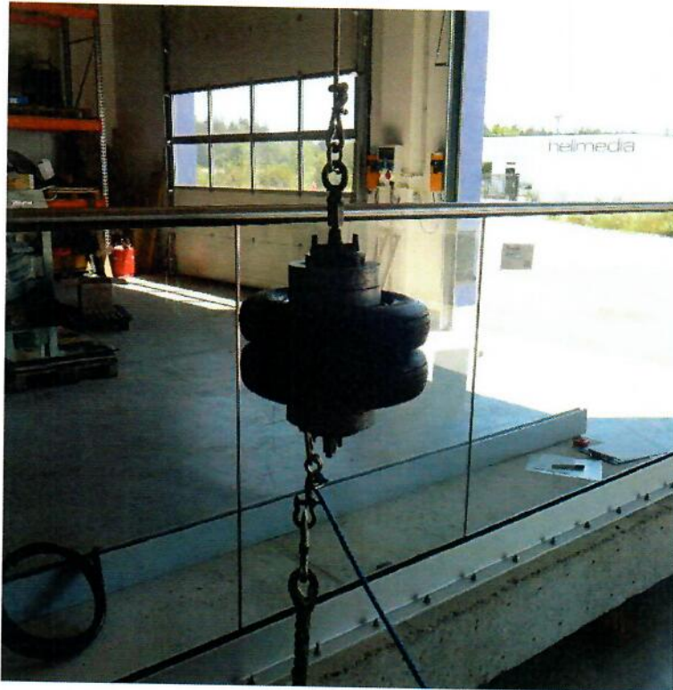
Abbildung V 01-7 Einrichtung des Pendels auf Stoßpunkt 1
