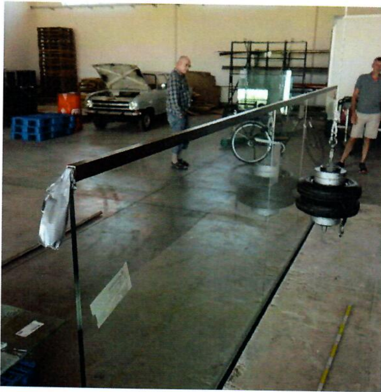
Abbildung V 03-7 Einrichtung des Pendels für Stoß auf Punkt 2
