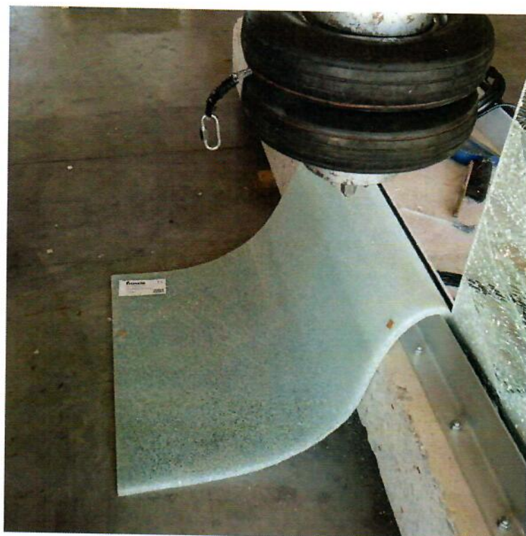
Abbildung V 01-21 Bruch der Scheibe 3
