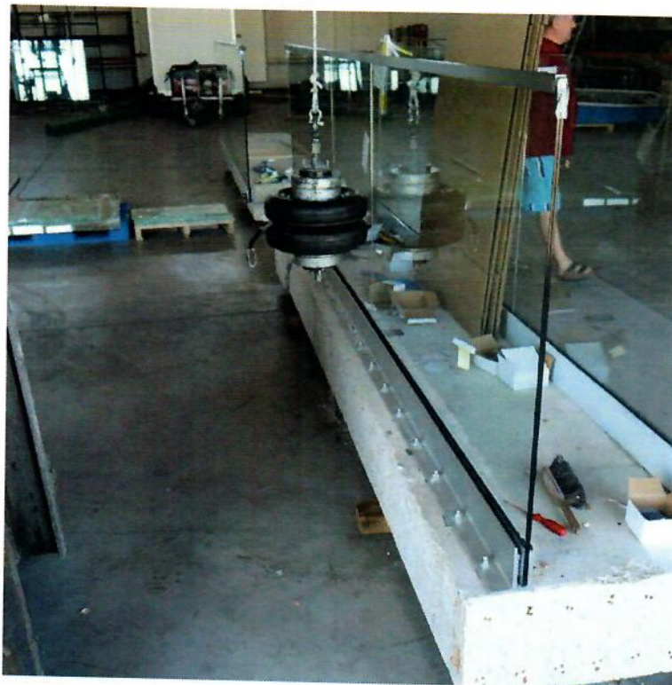
Abbildung V 04-4 Profil System AL-0006 nach Abschluss der Versuche mit Kantenschutz
