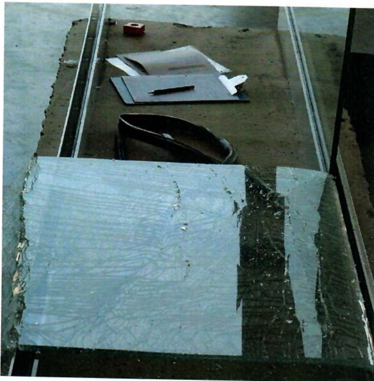
Abbildung V 01-14 Bruch der Scheibe
