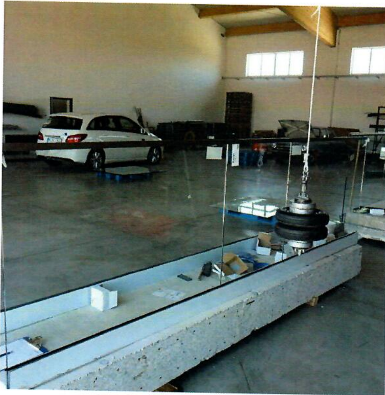
Abbildung V 02-13 Scheibe 1 nach Abschluss der Stoßversuche
