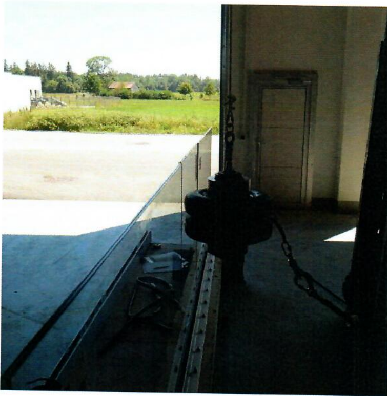
Abbildung V 01-13 System AL-0006, Test ohne Handlauf, Stoß auf Punkt 1
