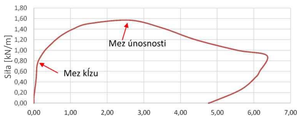
Wykres zależności odkształcenia górnej krawędzi profilu od siły
