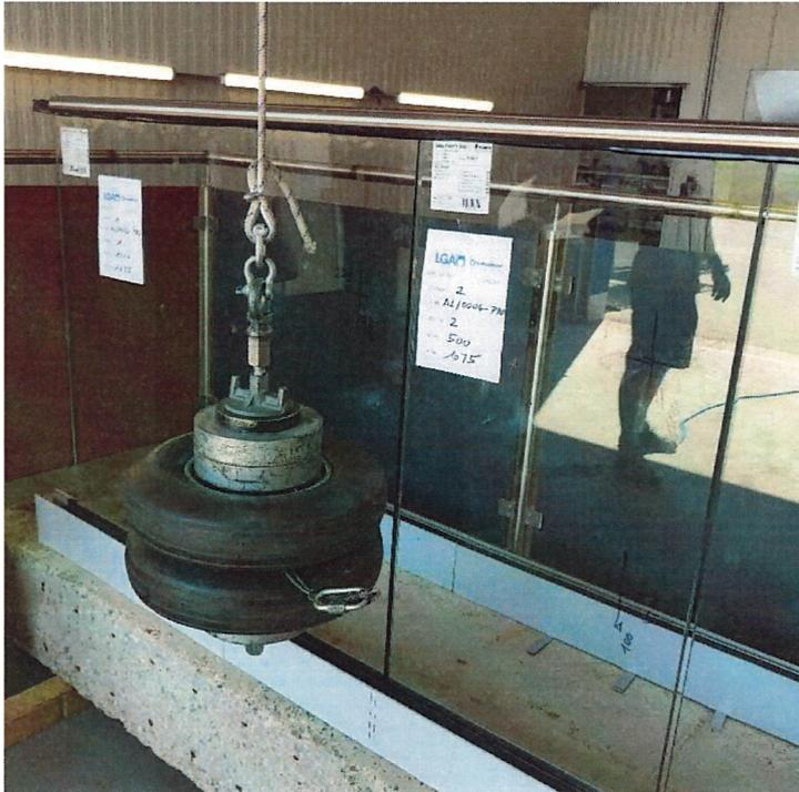
Abbildung V 01-14 Brüstung nach dem Stoß auf Punkt 2 der Scheibe 1
