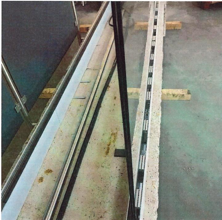
Abbildung V 01-6 Anordnung der Klemmsets im Profil
