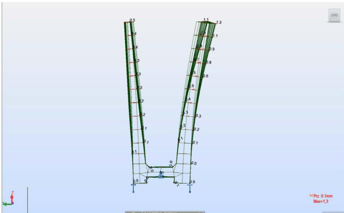
Maximálne vychýlenie zvislej steny profilu číni **1,3mm**.
