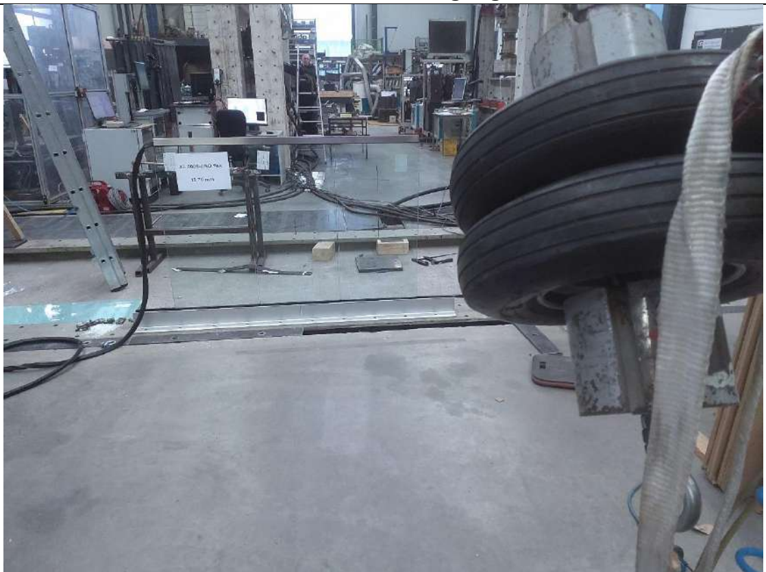
Versuchsaufbau 2 Pendelschlag mit einer Fallhöhe von \Delta h = 700 mm auf P2 → ohne Beschädigung
