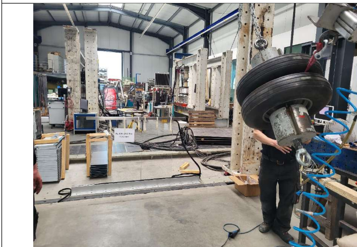
Zkušební sestava 3 Kyvadlový úder s pádovou výškou \Delta h = 700 \text{ mm} na P1 → Bez poškození
