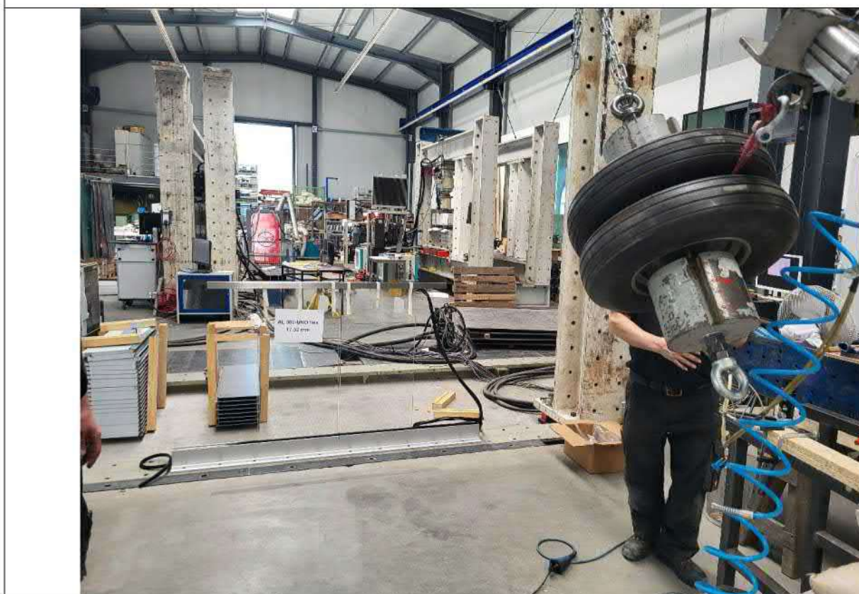
Konfiguracja testowa 2 Test udarności z wysokością upadku \Delta h = 700 \text{ mm} na P1 → brak uszkodzeń
