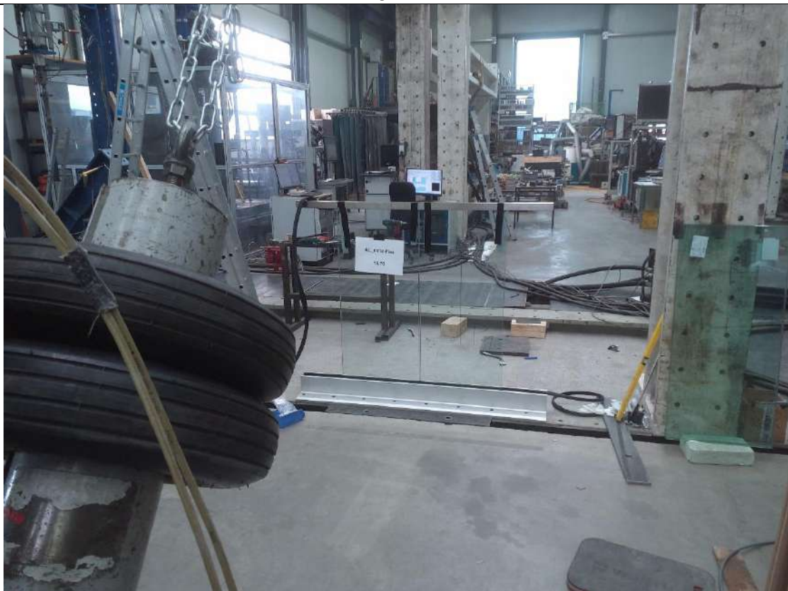
Zkušební sestava 6 Kyvadlový úder s pádovou výškou \Delta h = 700 mm na P1 → Bez poškození
