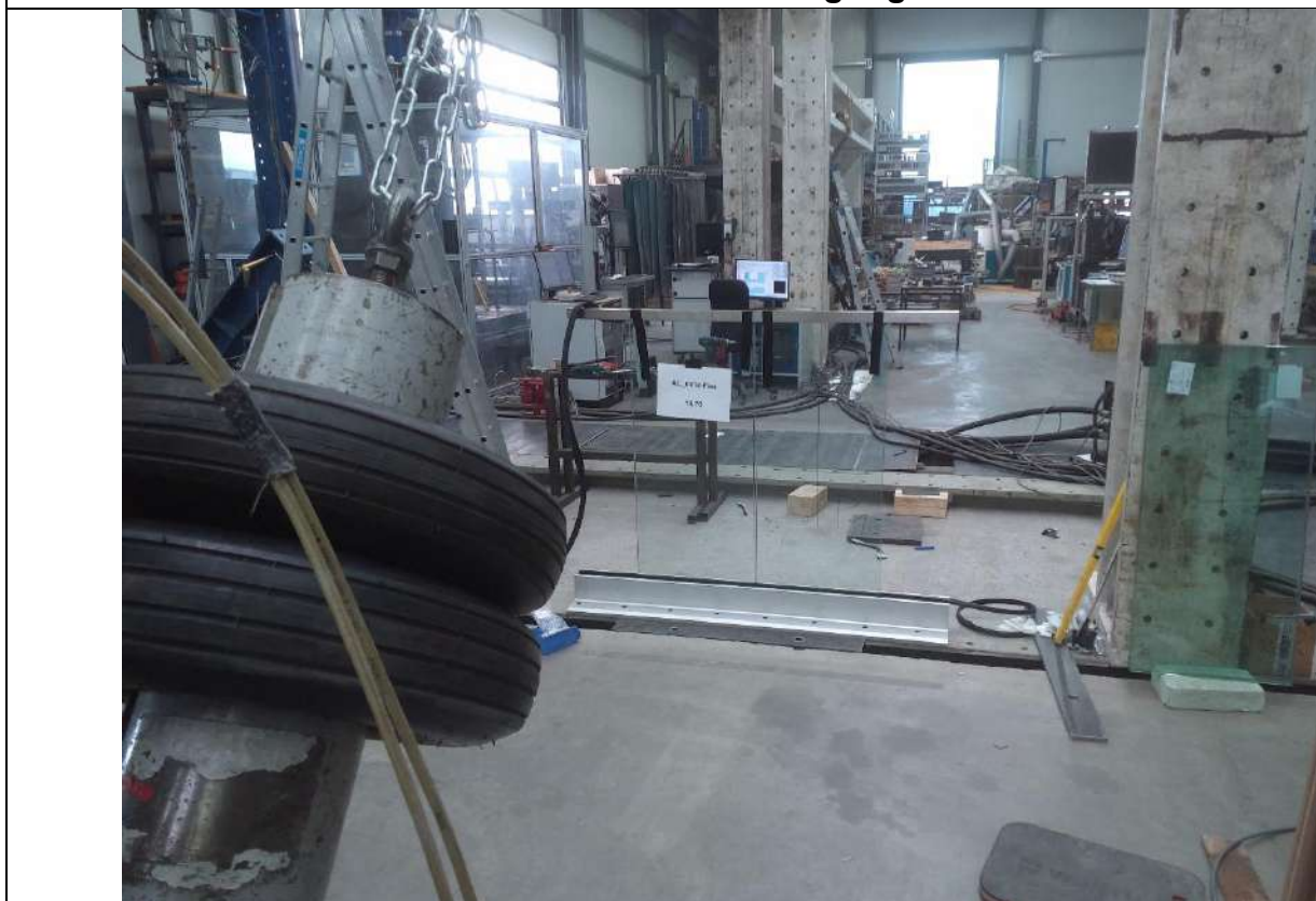
Versuchsaufbau 6 Pendelschlag mit einer Fallhöhe von \Delta h = 700 mm auf P1 → ohne Beschädigung
