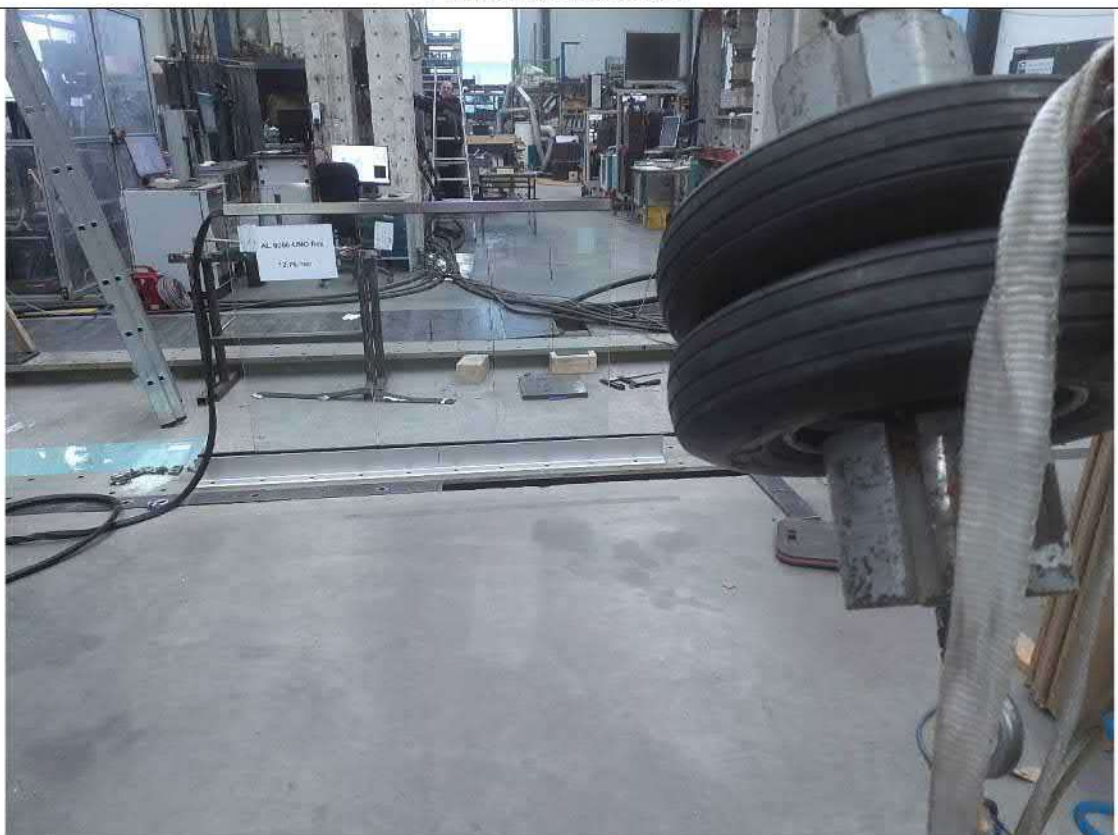
Konfiguracja testowa 2 Test udarności z wysokością upadku \Delta h = 700 mm na P2 → brak uszkodzeń
