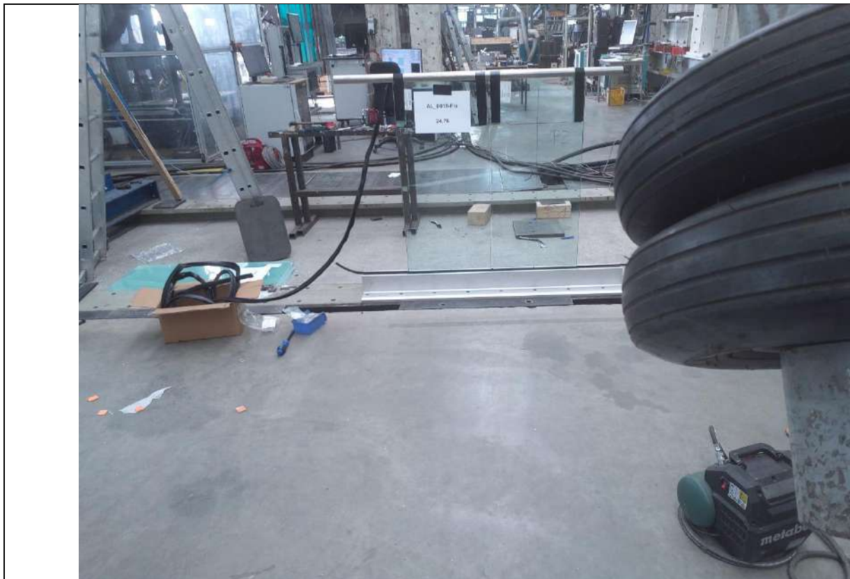
Versuchsaufbau 5 Pendelschlag mit einer Fallhöhe von \Delta h = 700 mm auf P2 → ohne Beschädigung
