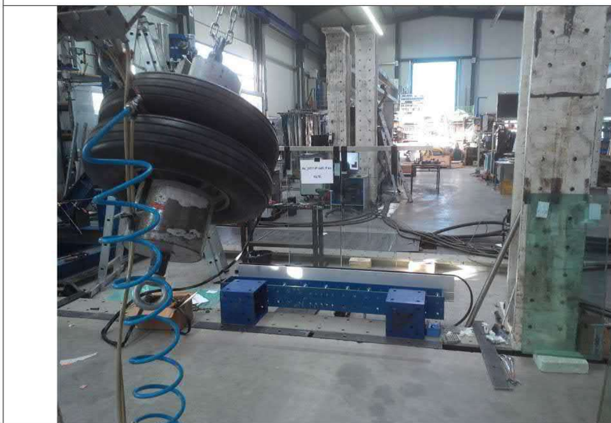
Konfiguracja testowa 4 Test udarności z wysokością upadku \Delta h = 700 mm na P1 → brak uszkodzeń
