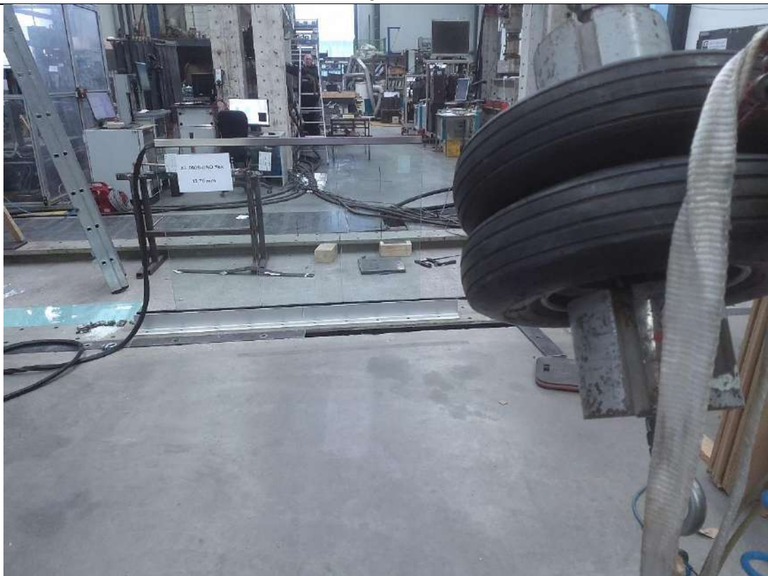
Zkušební sestava 2 Kyvadlový úder s pádovou výškou \Delta h = 700 \text{ mm} na P2 → Bez poškození
