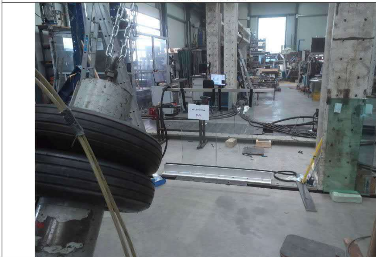
Konfiguracja testowa 6 Test udarności z wysokością upadku \Delta h = 700 mm na P1 → brak uszkodzeń
