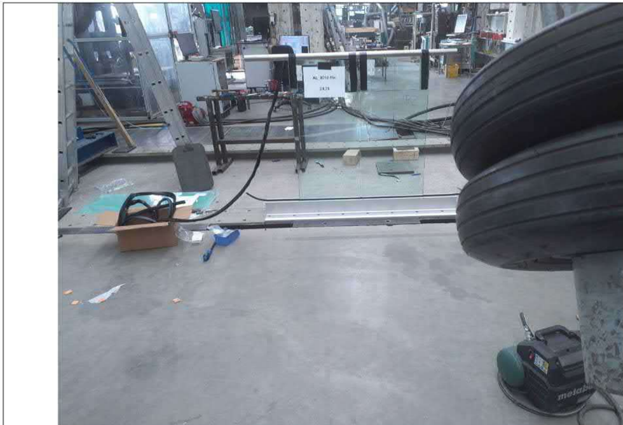
Konfiguracja testowa 5 Test udarności z wysokością upadku \Delta h = 700 mm na P2 → brak uszkodzeń
