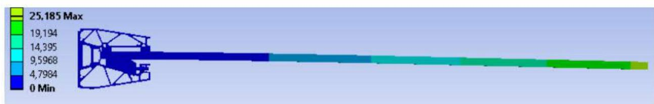
Graniczne ugięcie osiągnięte przy obciążeniu **2,55 kN/m<sup>2</sup>**
