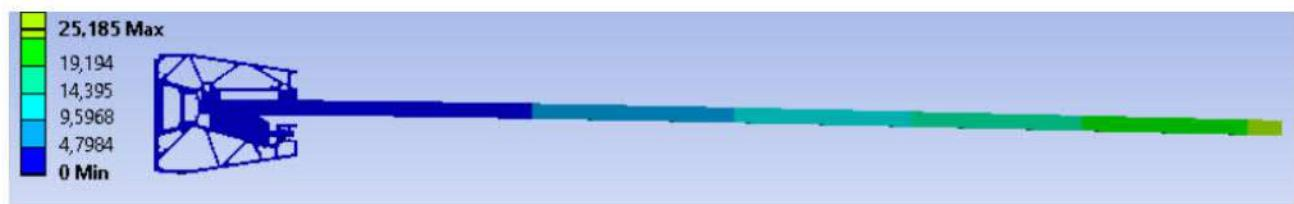
Die unter Belastung erreichte Grenzdurchbiegung **2,55 kN/m<sup>2</sup>**
