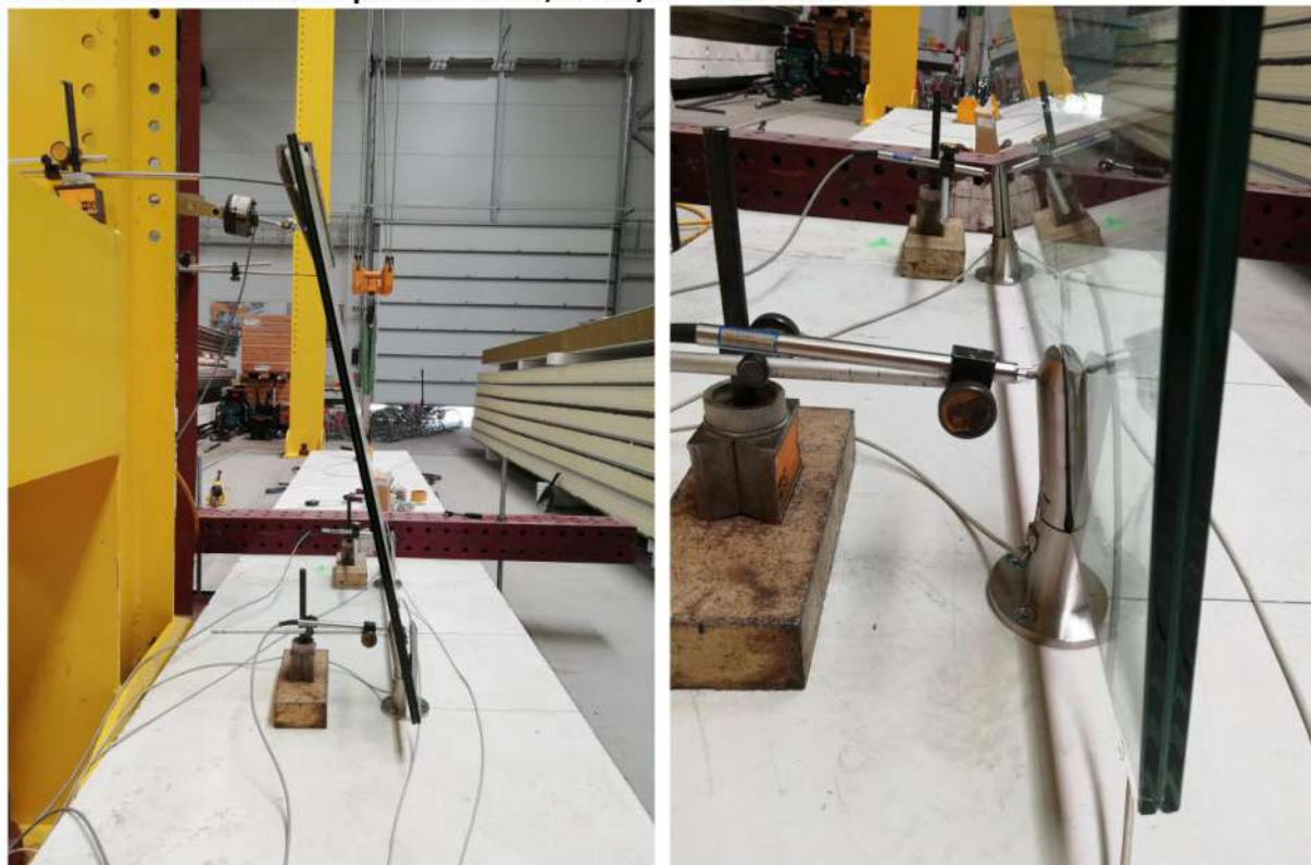
Deformované zábradlie pri zaťažení 0,50 kN/m' - 2x SPIGOT
